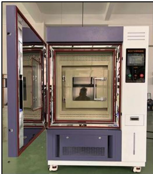
图 3 气体腐蚀试验箱
